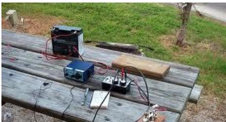
La operación en **QRP** consiste en limitar la potencia de los transmisores a 5W en [telegrafía](#) en [Código Morse](#) y a 10W en [banda lateral única](#).
