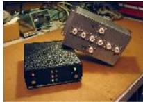
Construcción de Selector Remoto para 6 antenas y dos Transceptores.
